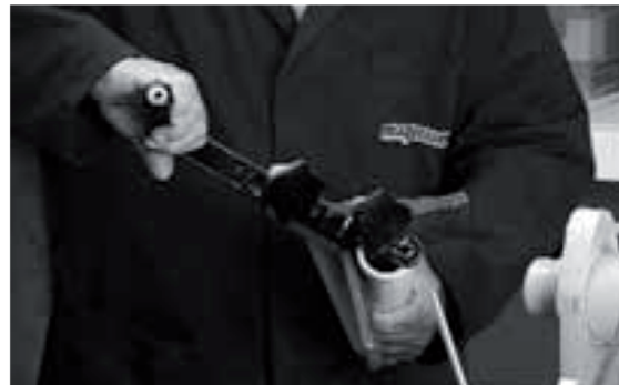
Obr.č.4: Koncovky rúr je potrebné zrezať paralelne, tzn. kolmo na svoju os a skosiť vzniknuté hrany. Vnútorňý priemer nátrubku, dĺžka nasunutia ako aj skosenie hrany rúry musí zodpovedať hodnotám udaným v tab. č.1. Skosenie má byť 15°. Skosenie hrán je možné vykonať sústružením alebo špeciálnymi kalibrovacími nástrojmi.
