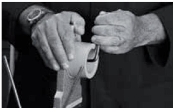
Obr.č.2: Vybrať potrebný rozmer nahrievacieho nátrubku a puzdra, a upevniť na telese zrkadla.
