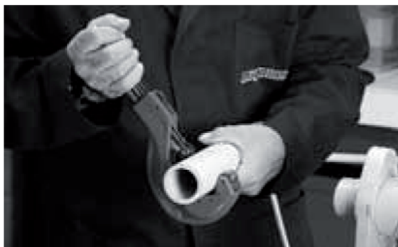
Obr.č.4: Koncovky rúr je potrebné zrezať paralelne, tzn. kolmo na svoju os a skosiť vzniknuté hrany. Vnútorňý priemer nátrubku, dĺžka nasunutia ako aj skosenie hrany rúry musí zodpovedať hodnotám udaným v tab. č.1. Skosenie má byť 15°. Skosenie hrán je možné vykonať sústružením alebo špeciálnymi kalibrovacími nástrojmi.
