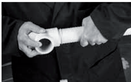
Obr.č.8: Po uplynutí doby nahrievania rúru a tvarovku z nahrievacieho telesa treba rýchlo odstrániť a treba ich rýchlo vsunúť do seba až po značku. Treba sa vyvarovať vzájomného pootáčania sa súčiastok!
