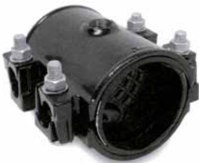
**Stop Spojka** - účinná oprava hrdlových spojov a spojov hladkých koncov hrdlovej trubky. Vhodné pre liatinu, tvárnu liatinu apod. EasiCollar možno inštalovať pod tlakom a je k dispozícii vo veľkostiach DN80 a viac. Podľa požiadavky môže mať náter Rilsan Nylon 11, Scotchkote 206N alebo prechodný náter.
