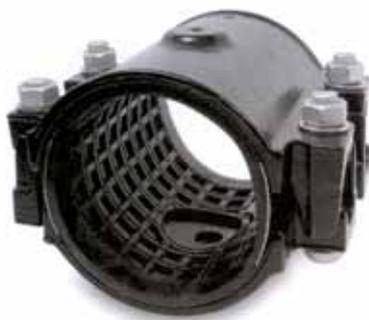
**MattSeal opravárenský strmeň** DN350 – DN1000, navrhnutý pre opravy rúr s väčším priemerom, má jedinečné kazetové tesnenie a ponúka plnú podporu pre poškodené rúry.
