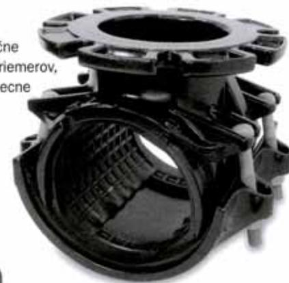
**RingSeal EasiTee** DN350 až DN1200. T-kus odbočkovej prípojky s tesnením okolo výstupného hrdla odbočky. Vhodné pre výstupné veľkosti do 600 mm. (alebo 70% priemeru hlavnej rúry na liatinových rúrach). Lacnejšia alternatíva k MattSeal EasiTee pre mnohé aplikácie.
