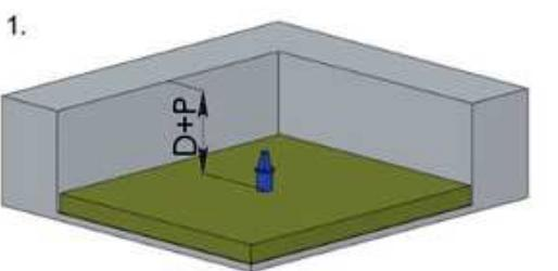
1. V mieste inštalácie poklopu je potrebné zhutniť podkladovú vrstvu na potrebnú hodnotu do výšky ktorá po pripočítaní hrúbky podkladovej dosky a výšky poklopu bude zodpovedať úrovni konečného povrchu.
