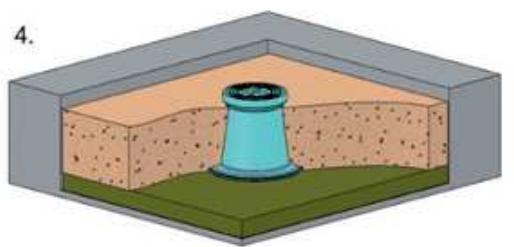
4. Vykonáť obsyp zodpovedajúcim materiálom s ohľadom na silu a typ záverečnej úpravy terénu. Obsyp musí byť dostatočne zhutnený.
