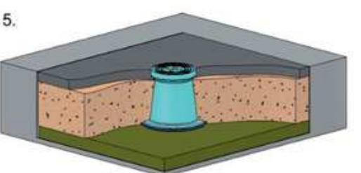
5. Vykonáť položenie záverečnej vrstvy (vrstiev) príslušného materiálu.
